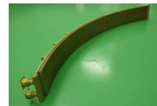
長さ2mの熱交換器ユニット
