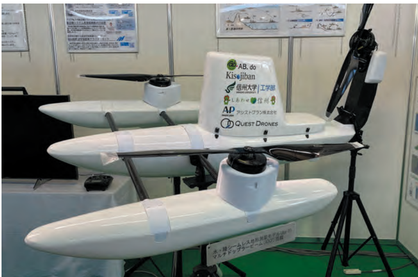
【クエストコーポレーションが開発した多機能／多用途型水・空ドローン】
