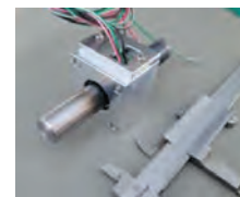
【磁歪式トルクセンサの試作品】 ※磁歪膜溶射膜後のシャフト及び専用ICを組み込
