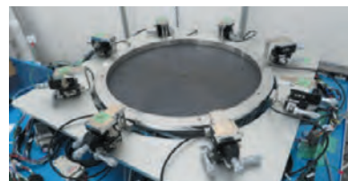
【開発した大口径(Φ400mm超)円筒格子スケールを用いた光学式3Dロータリエンコーダ】
