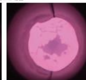
インゴットの形が 消えた瞬間(=溶け落ち点) → 2~3秒後に鑄造
