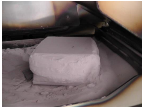
Fig. 造形品を含む仮焼結粉ブロック
