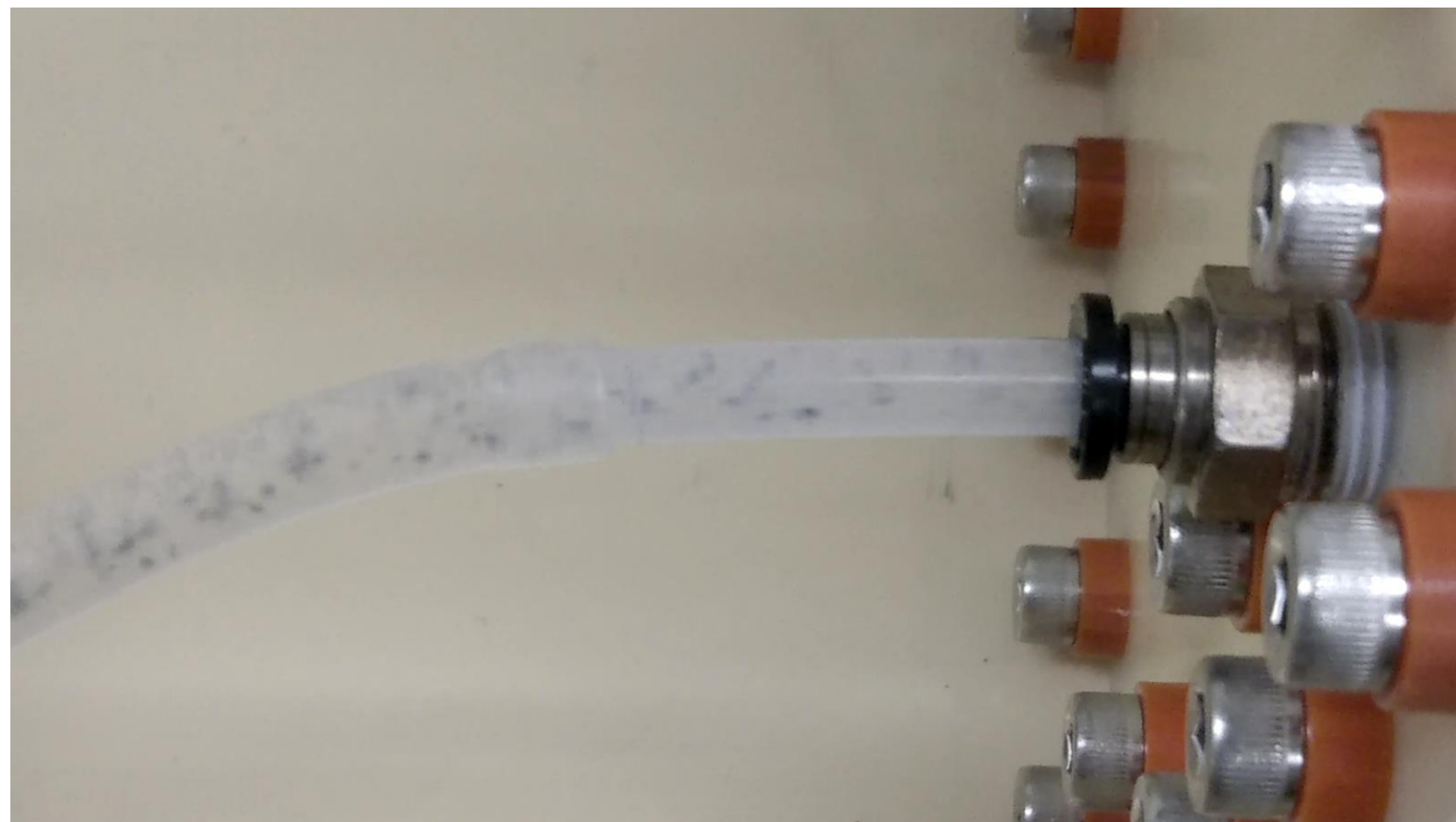
フロー型亜鉛再生部セルにおける粒子状亜鉛生成
