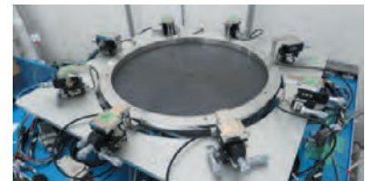
【開発した大口径(Φ400mm超)円筒格子スケールを用いた光学式3Dロータリエンコーダ】
