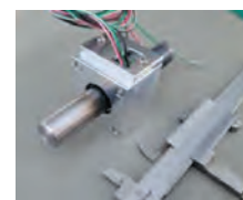
【磁歪式トルクセンサの試作品】 ※磁歪膜溶射膜後のシャフト及び専用ICを組み
