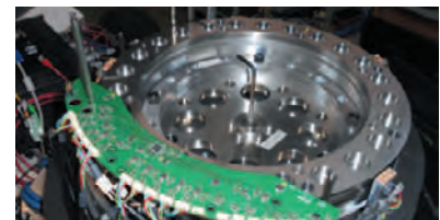
【開発した大口径(Φ400mm超)はすば歯車を用いた磁気式3Dロータリエンコーダ】
