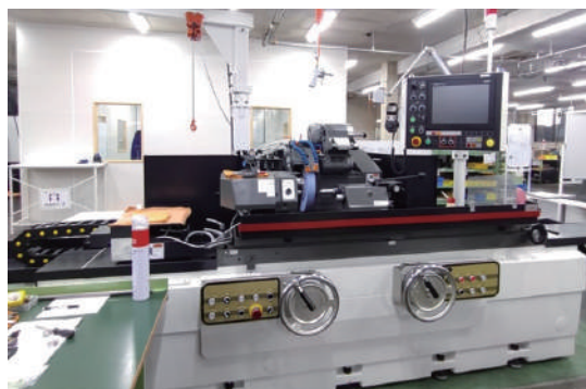
導入した円筒研削盤（IoTキット導入後）
