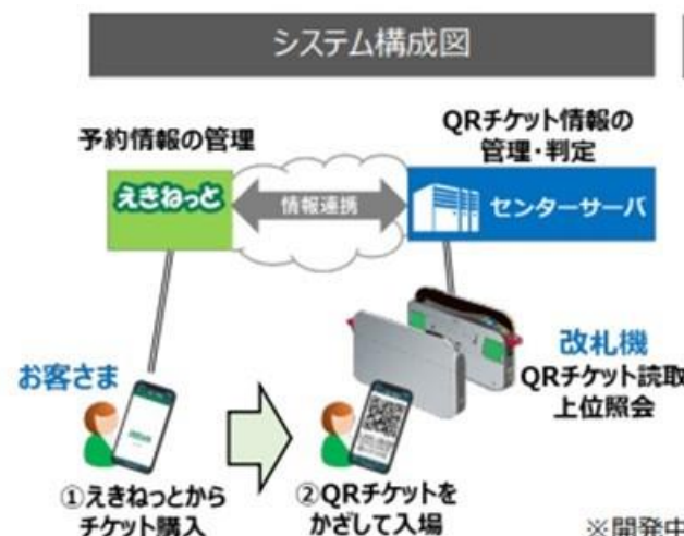
新型自動改札機(在来線用)への QR リーダー設置例
