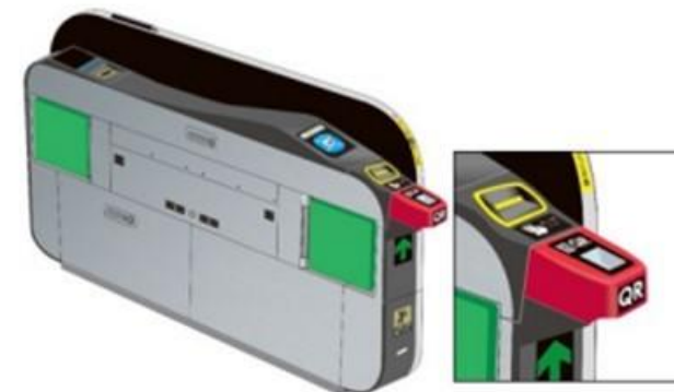
新型自動改札機(在来線用)への QR リーダー設置例
